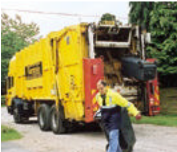
ゴミ回収車は自動的にゴミ箱を持ち上げる。
