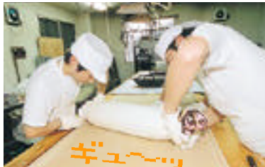
▲さらに、ふたりがかりで引っ張りながら両端を絞る。伸ばすときに部品がズレないようにするためだ。
