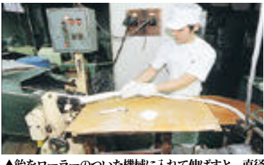
▲飴をローラーのついた機械に入れて伸ばすと、直径2 ほどの細い棒飴になって出てくる。まだ、かなりやわらかい。
